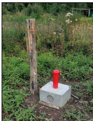
Afin de suivre l'évolution de la hauteur de nappe superficielle dans le sol, chaque zone humide a été équipée d'un piézomètre. Celui-ci est relevé de manière régulière.
